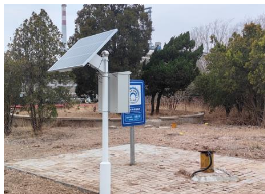
图 5.2 污水池泄漏油敏传感在线检测 图 5.3 地下水在线监测设备
