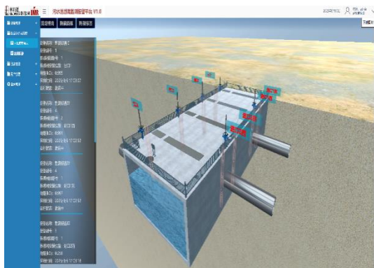
图 5.2 污水池泄漏油敏传感在线检测 图 5.3 地下水在线监测设备
