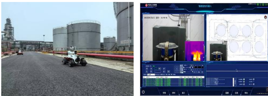
图 5.1 多维感知智能巡检机器人及平台
