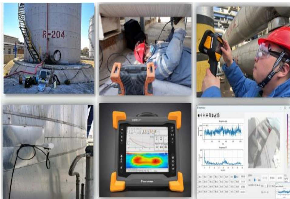
图 5.4 储罐不开罐腐蚀检测技术
