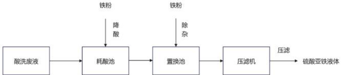
图 2 酸洗废液置换生产硫酸亚铁溶液流程示意图
