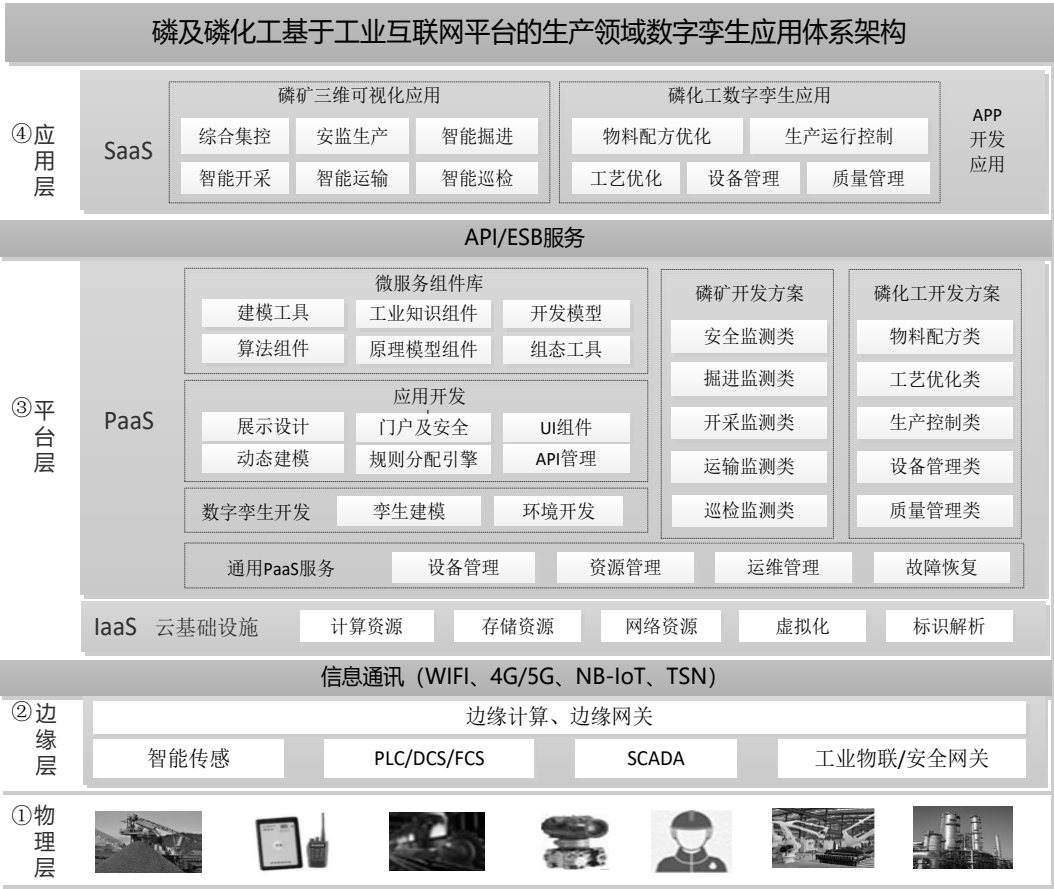
图 1 磷及磷化工基于工业互联网平台的生产领域数字孪生应用体系架构
