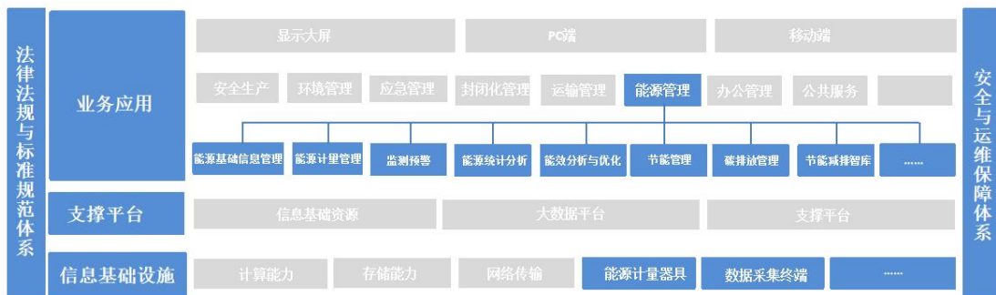
图 1 智慧化工园区能源管理系统架构图
