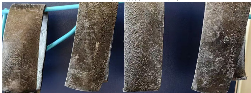
图 3 浸入 1#粉末隔离剂胶片干燥后
