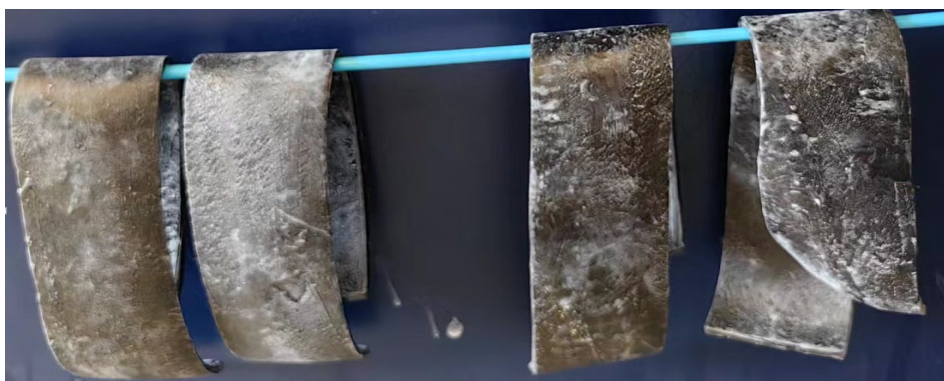
图 4 2#粉末隔离剂胶片干燥后
